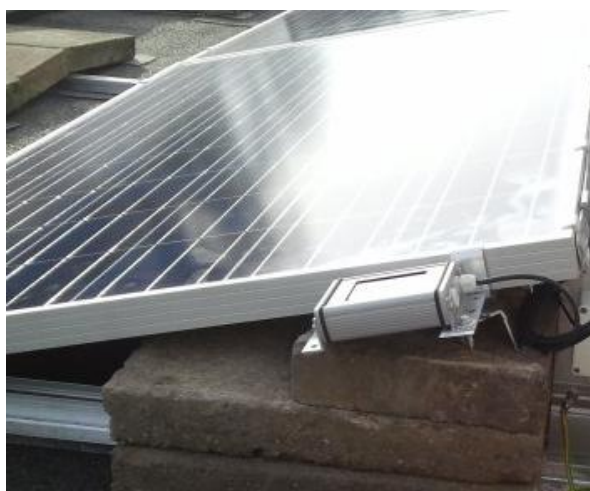
Abbildung 8: Einstrahlungssensor mit integriertem Modultemperaturfühler
