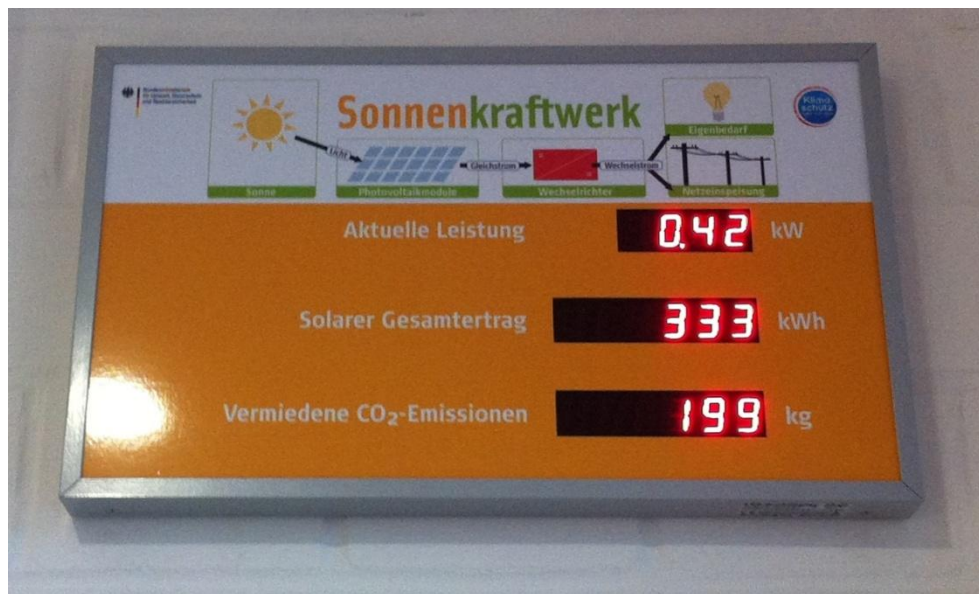
Abbildung 6: Anzeigetafel HVG, IP20 Innenmontage, 50 x 30 cm
