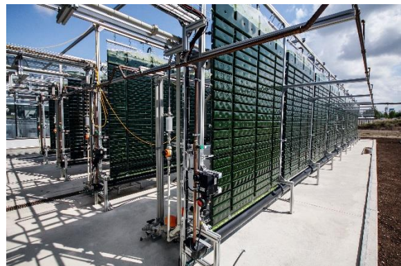
180-Liter-Reaktormodule der Freilandanlage am Fraunhofer Institut in Leuna
