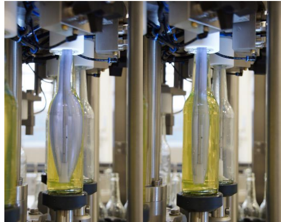
Getränkeabfüllung mit dem Ballon-Style-Verfahren
