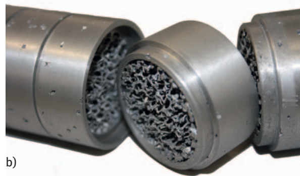
Abb. 2: Probenaufnahme (a) mit Proben und Heizelementen sowie Gehäusemodulen (b).
